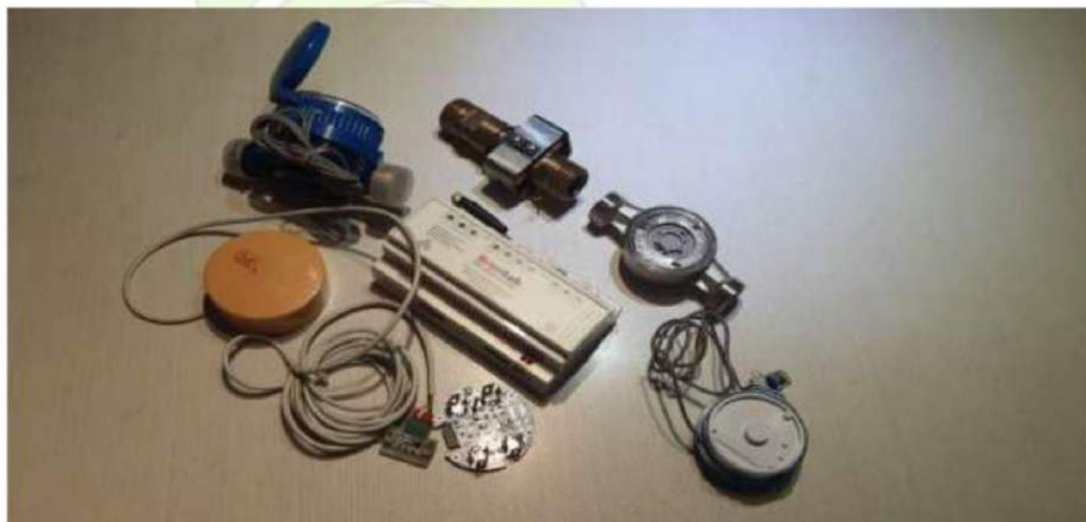
شکل ۲-۲ تصویر کنتور آب به همراه خوانشگر شرکت برون‌تاب انرژی
